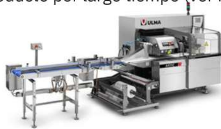
F1. Bandeja de pescado cod empacada con maquinaria de última tecnología ARTIC flow pack wrapper (HFFS) de la marca ULMA.
