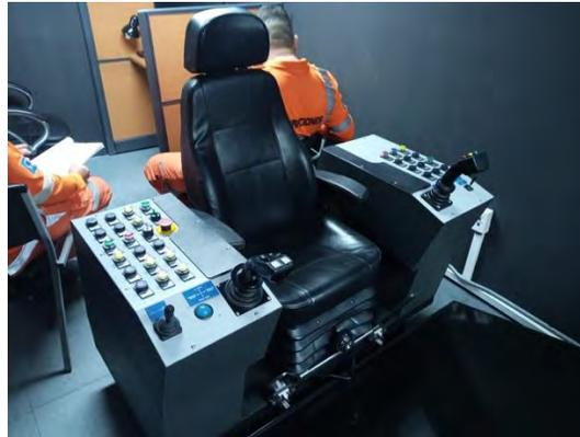
*Ilustración 4 Simulador de grúa móvil de la OPC, fuente: OPC*
