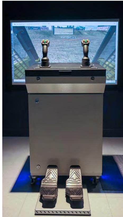
*Ilustración 2 Pedalera y accionamientos de un simulador de maquinaria pesada, fuente: etechsimulation.com*
