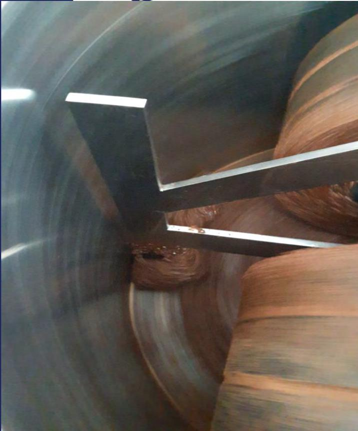
Los nibs de cacao se va vertiendo al refinador lentamente conforma va liberándose la fracción grasa hasta convertirse en líquido, este proceso culmina hasta cuando el licor o masa de cacao logra 70 a 100 micrones
